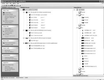
GX Configurator DP est un logiciel de configuration ergonomique pour le réseau ouvert Profibus DP.
